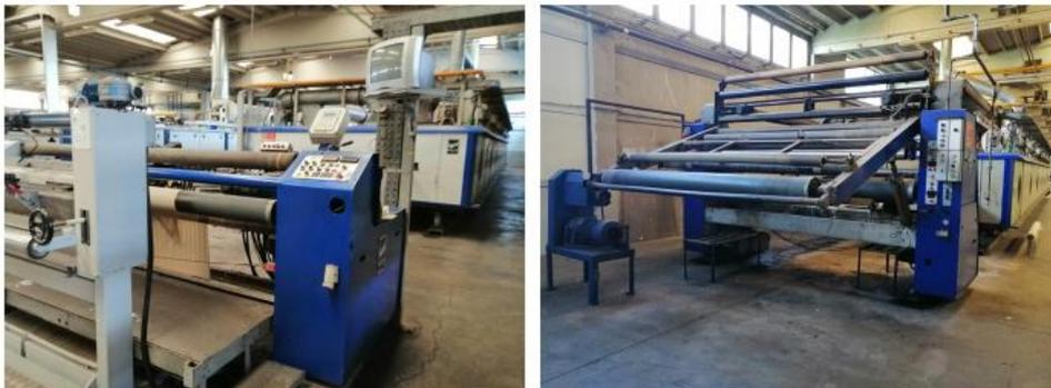
Rameuse Reggiani 6 campi gas - a pinze completa di foulard Ciprandi 2 cilindri
