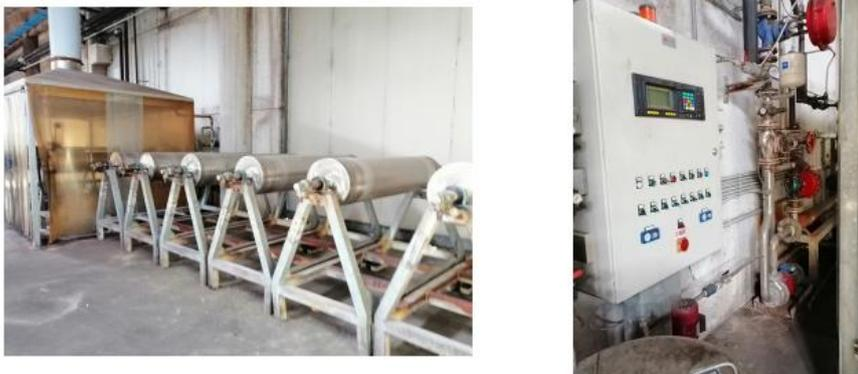
Impianto di lavaggio Flush Batch - 3 posizioni - N. 8 carrelli forati in dotazione
