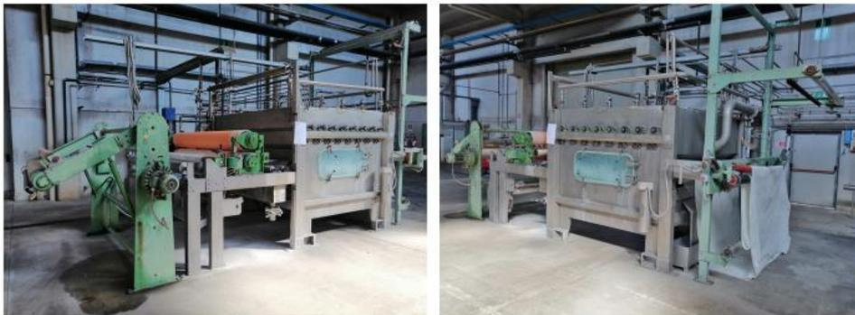
Vasca MCS di purga / sbozzima / sodatura / candeggio con dosaggio automatico bagni – Altezza mm 2000 – Anno 1995 – Macchina assemblata internamente – Obsoleta
