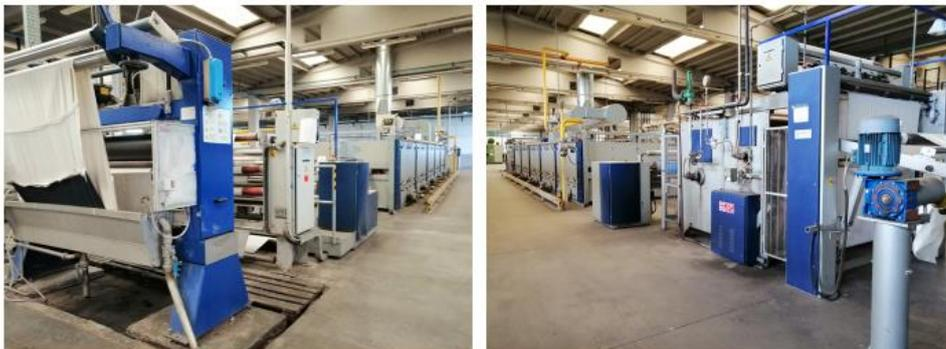
Rameuse BTM 5 campi gas - pinze/spilli completa di foulard Beta 2 Cilindri / Mahlo serie 10 A/ - Calandra a feltro in uscita – Altezza mm 1800 – Anno 2001 – TdS 6,0 giorni (parte elettrica) + TdS 24,0 giorni (parte meccanica) – Utilizzabile solo dopo ri-installazione di circa 30 giorni –
