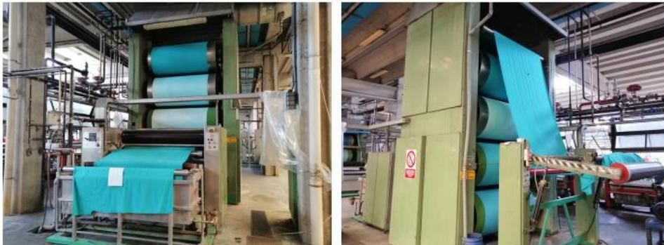
Asciugatoio a vapore 8 cilindri dia. 80 cm Paganini completo di foulard impregnazione e arrotolatore assiale in uscita – Altezza mm 1800 – Anno 1997 – TdS: 4,0 giorni – Utilizzabile subito –
