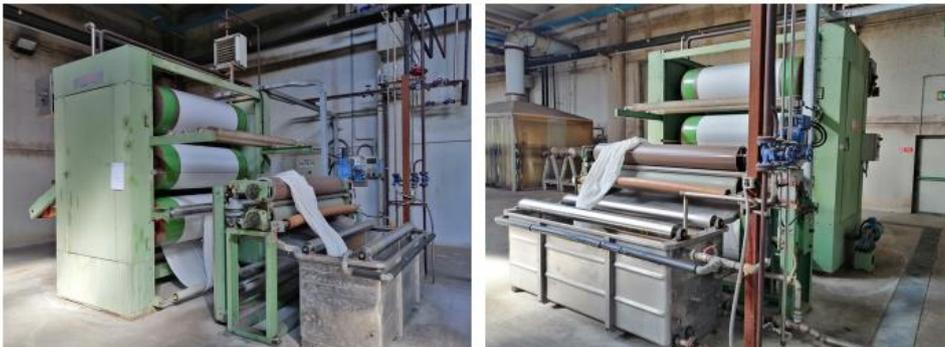
Asciugatoio a vapore 6 cilindri diametro 60 cm Ramallumin completo di foulard
