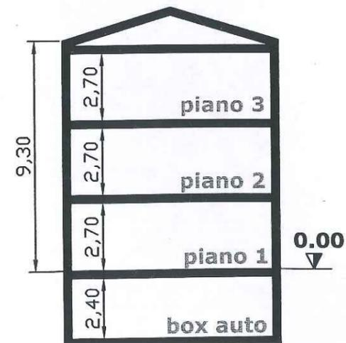
SEZIONE - SCHEMA TIPO PALAZZINA
