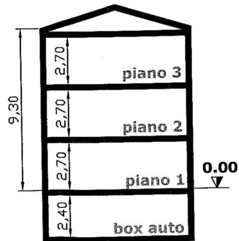
SEZIONE - SCHEMA TIPO PALAZZINA
